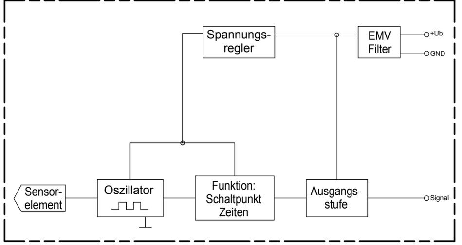
**Funktionsdiagramm für MAXIMUM Sonden**
