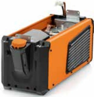
Schnell zu montierende Kühleinheit X5 Cooler mit Funktion Auto/EIN/AUS. Einfache Befüllung und Kontrolle des Kühlmittelstands. Die dynamische Kühlung reduziert den Stromverbrauch und die Geräusentwicklung. Die Kühleinheit gewährleistet mit einem einstellbaren Durchsatzsensor und Filter kontinuierliche Kühlung.
