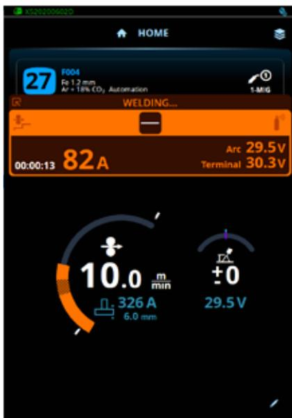
Sehen Sie sich die Schweißwerte an und passen Sie die Parameter an, während der Roboter schweißt.
