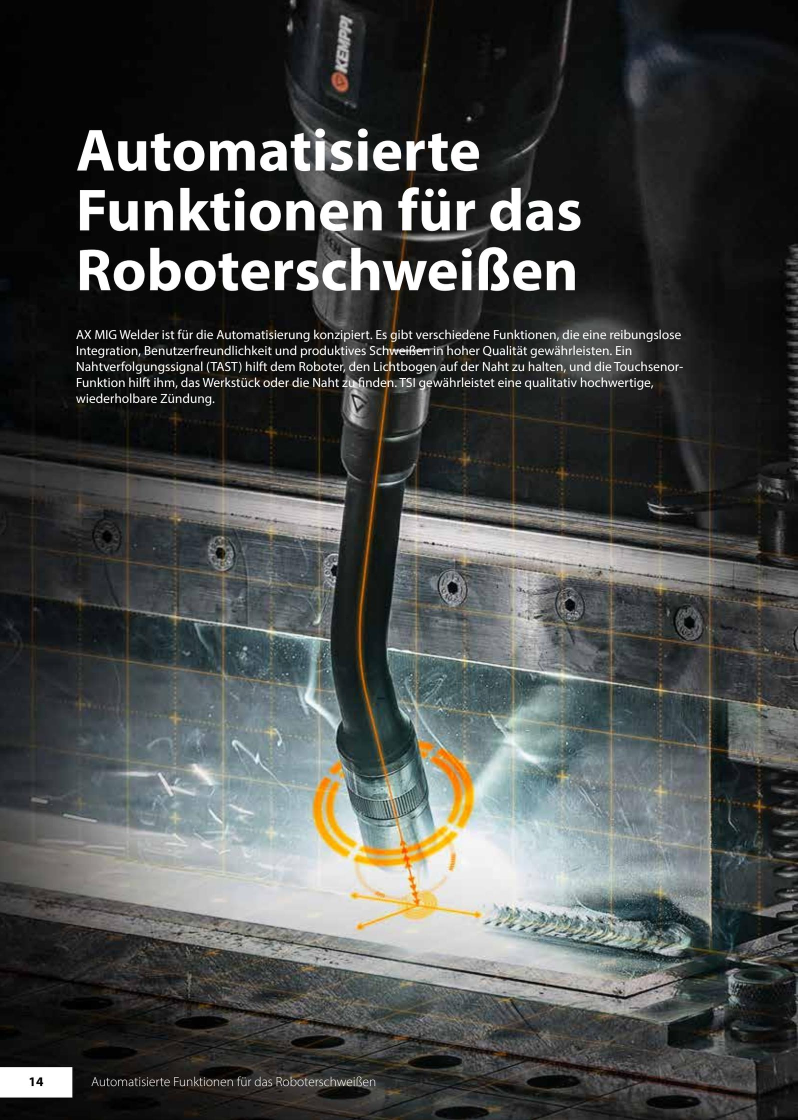
AX MIG Welder ist für die Automatisierung konzipiert. Es gibt verschiedene Funktionen, die eine reibungslose Integration, Benutzerfreundlichkeit und produktives Schweißen in hoher Qualität gewährleisten. Ein Nahtverfolgungssignal (TAST) hilft dem Roboter, den Lichtbogen auf der Naht zu halten, und die Touchsenor-Funktion hilft ihm, das Werkstück oder die Naht zu finden. TSI gewährleistet eine qualitativ hochwertige, wiederholbare Zündung.
