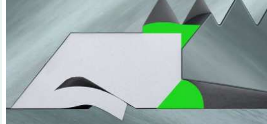
Verschraubung mit Schneidring und Weichdichtung
