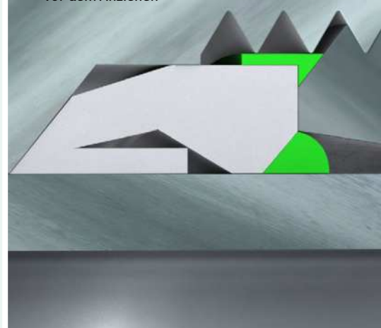
Verschraubung mit Schneidring und Weichdichtung vor dem Anziehen
