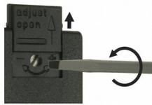
Eine Drehung im Uhrzeigersinn sorgt für einen kleineren Schaltpunkt, eine Drehung gegen den Uhrzeigersinn für einen höheren Schaltpunkt. Nach der Einstellung den Schieber wieder schließen.
