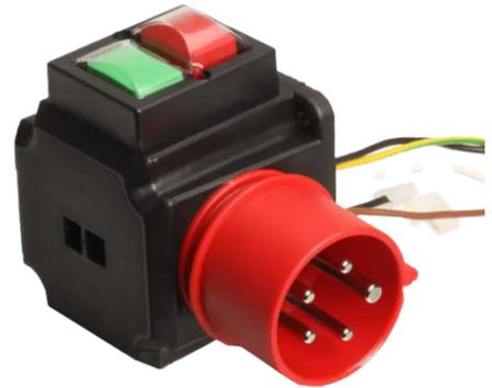
Unterspannungsauslösung nach IEC204-1, EN60204, VDE0113, Abschnitt 7.5., zum Schutz gegen selbstständigen Wiederanlauf nach Spannungseinbruch und Spannungswiederkehr
