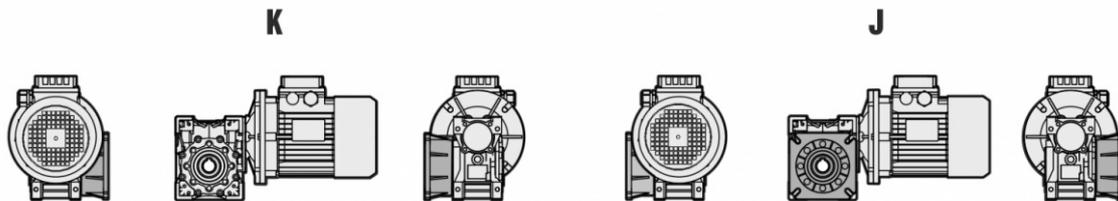
Falls nicht anders vereinbart, wird das Getriebe mit Flansch in Position J, auf die B3 Einbaulage bezogen, geliefert.
