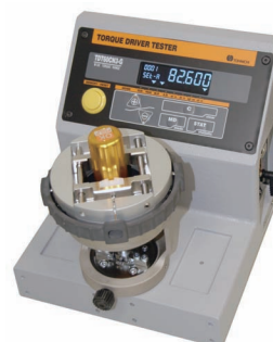
Abbildung einer Kalibrierung der drehmoment Schraubendreher RTD links und FTD rechts mit TDT3-G
