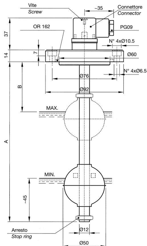
**MATERIALI:** flangia, tubo, anelli di arresto e galleggiante in acciaio Inox.
