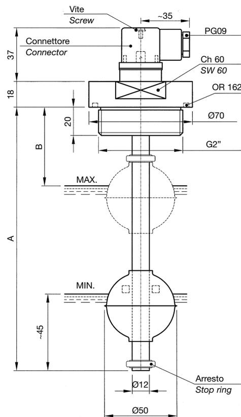
**MATERIALI:** flangia filettata, tubo, anelli di arresto e galleggiante in acciaio Inox.
